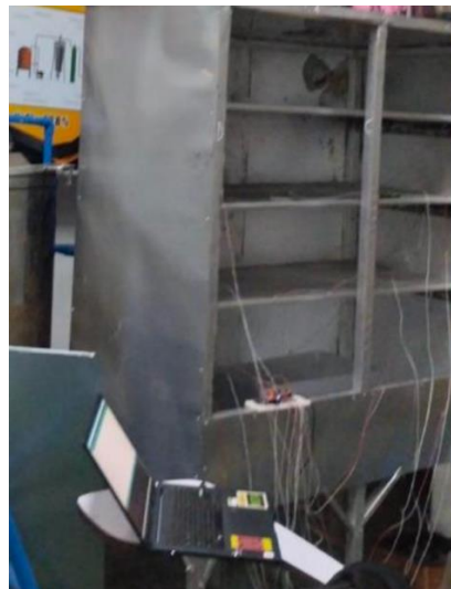
Gambar 5. Proses kalibrasi load cell pada lemari pengering
